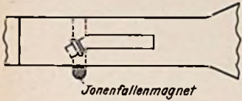
Bild 2. Schematische Anordnung der Ionenjalle
