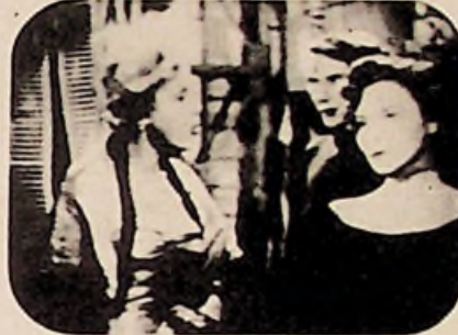
Bild 74. Zu starker Bildkontrast durch Übersteuerung der Bildröhre. (Aus der Fernseh-Bildfehler-Fibel von O. P. Herrnkind; Radio-Praktiker-Bücherei, Band 51)
