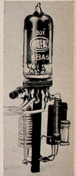
Praktische Einzelteilanordnung bei modernen Röhrenfassungen. Mit Hilfe eines Isolierröhrchens werdendie Schaltelemente in Längsrichtung zur Röhrenachse angeordnet
